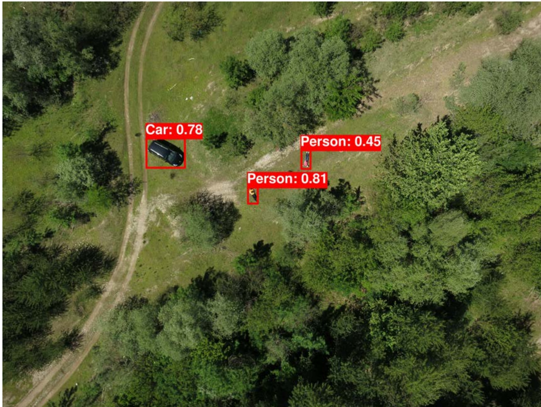
Figur 3.9: Detektion av objekt i en bild med hjälp av en objekt-detektor som tränats på bilder av bilar respektive människor. Varje detekterat objekt har markerats med en röd låda samt tilldelats en etikett och ett sannolikhetsvärde. Bildkälla [16].
