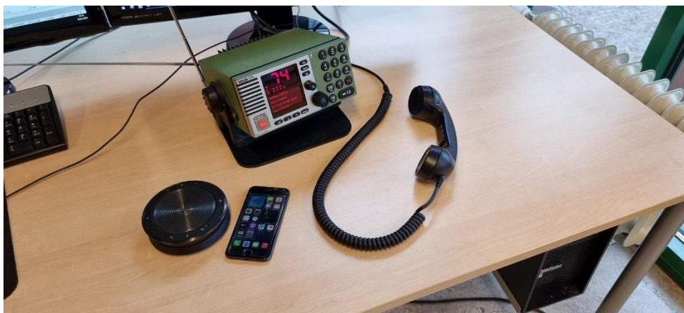
Bild 1 VHF radio, det traditionella sättet att kommunicera mellan land och fartyg, eller fartyg-fartyg samt en mobiltelefon med högtalare. Ett enkelt sätt att skapa en ”öppen lina” mellan fartyget och lotsen i land.
