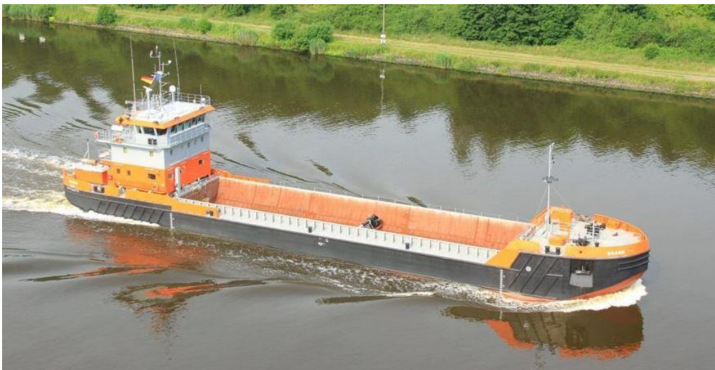
Figur 8. Exempel på självgående (ej bogserad) muddpråm.
