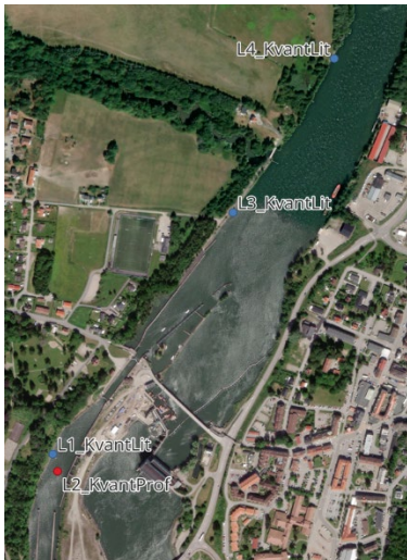
Figur 23. Lokaliseringen av de fyra olika punkterna där proverna togs den 18 september 2023 i Lilla Edet är följande: L1, L2, L3 och L4. Kvant indikerar kvantitativ provtagning, medan en blå punkt betyder att ett sparkprov togs och en röd punkt betyder att ett huggprov togs.
