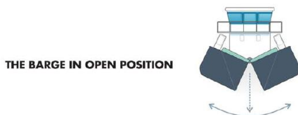
Figur A-2 Botten tömmande pråm, s.k. split barge . Källa Boskalis ( boskalis.se ).
