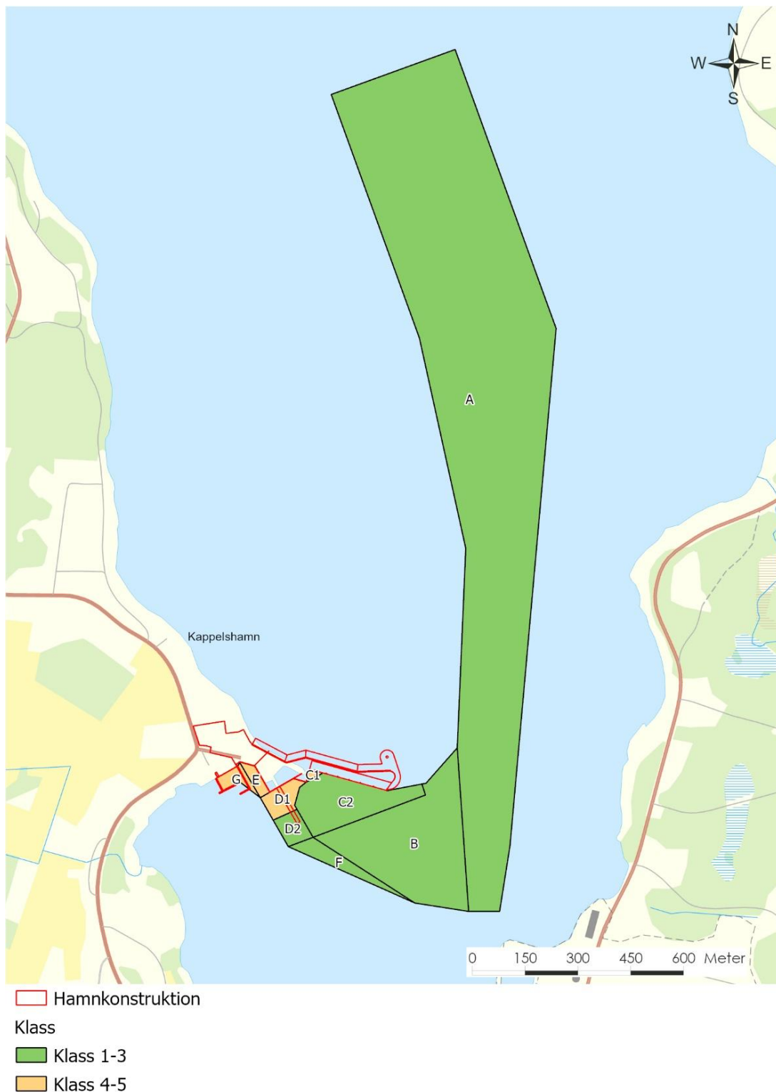
Figur 2. Zoner med sediment av föroreningsklass 4-5 (enligt Naturvårdsverkets och SGUs bedömningsgrunder) i orange samt områden med sediment av föroreningsklass 1-3 i grönt. Klassningen baseras på undersökningar utförda år 2023 och 2024 och klassningen motsvarar den översta halvmeteren av botten sedimentet.
