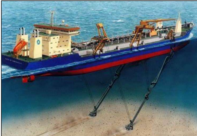
Figur 5-10. Trailing Suction Hopper Dredger, även kallat sugmuddring.
