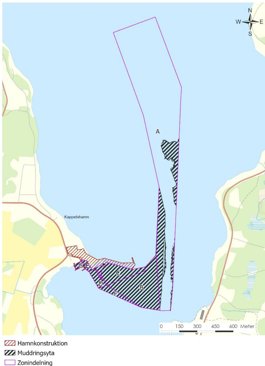
Figur 13. Figur som visar den nya hamnanläggningens utbredning samt muddringsytor.
