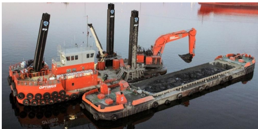
Figur 15. Exempel på mudderverk för grävuddring.
